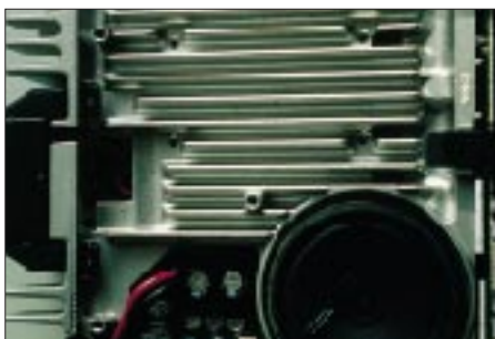
Die Gehäusekonstruktion sorgt für sichere Wärmeableitung.
