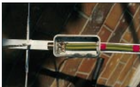
Bild 6: Die Dose mit der Koaxialbuchse zum Anschluß des Antennenkabels bei der 2-Element-Yagi
