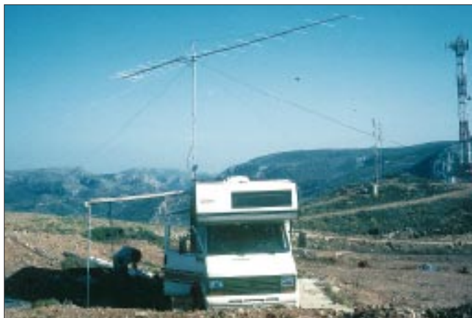
Die 2-m-Meteorscatter-Station: Von hier aus gelangen mit 3CX800 an einer 17-Ele.-M 2 etliche QSOs über mehr als 2000 km.
